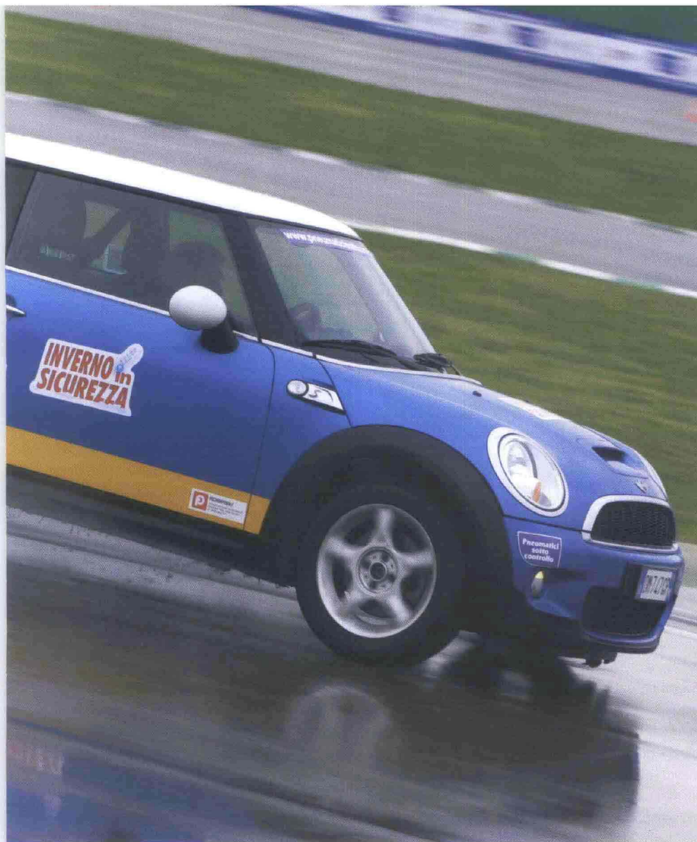
Per effettuare i test, l'asfalto è stato raffreddato con ghiaccio secco: la temperatura del fondo è controllata dai tecnici con strumenti professionali.
