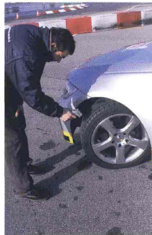
A sinistra, il differente comportamento di pneumatico invernale, nella foto piccola, ed estivo: alla stessa velocità, il secondo, su fondo freddo, perde più facilmente aderenza, innescando un evidente sovrasterzo. Sopra, anche le temperature dei pneumatici sono state costantemente monitorate.
