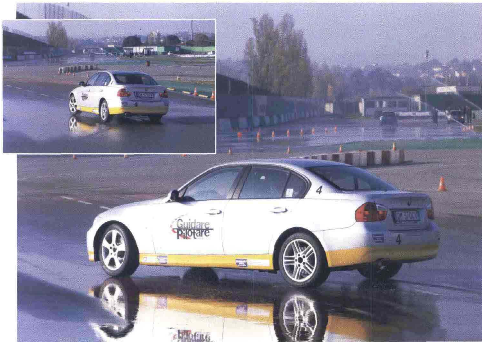
A sinistra, il differente comportamento di pneumatico invernale, nella foto piccola, ed estivo: alla stessa velocità, il secondo, su fondo freddo, perde più facilmente aderenza, innescando un evidente sovrasterzo. Sopra, anche le temperature dei pneumatici sono state costantemente monitorate.
