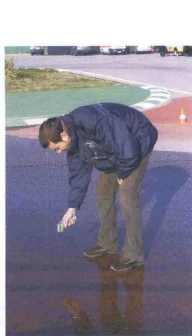
Per effettuare i test, l'asfalto è stato raffreddato con ghiaccio secco: la temperatura del fondo è controllata dai tecnici con strumenti professionali.
