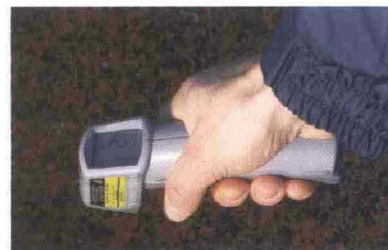
Per effettuare i test, l'asfalto è stato raffreddato con ghiaccio secco: la temperatura del fondo è controllata dai tecnici con strumenti professionali.
